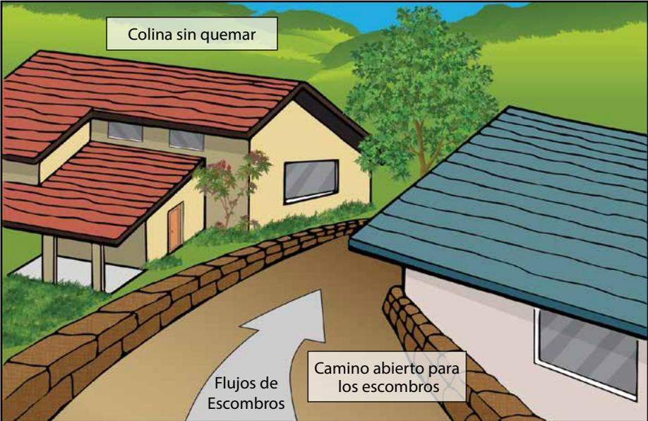
Fig. 9 - Dirigiendo los Flujos a Través de los Edificios
