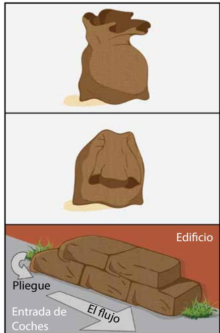
Fig. 4 - Colocación de Bolsas de Arena
