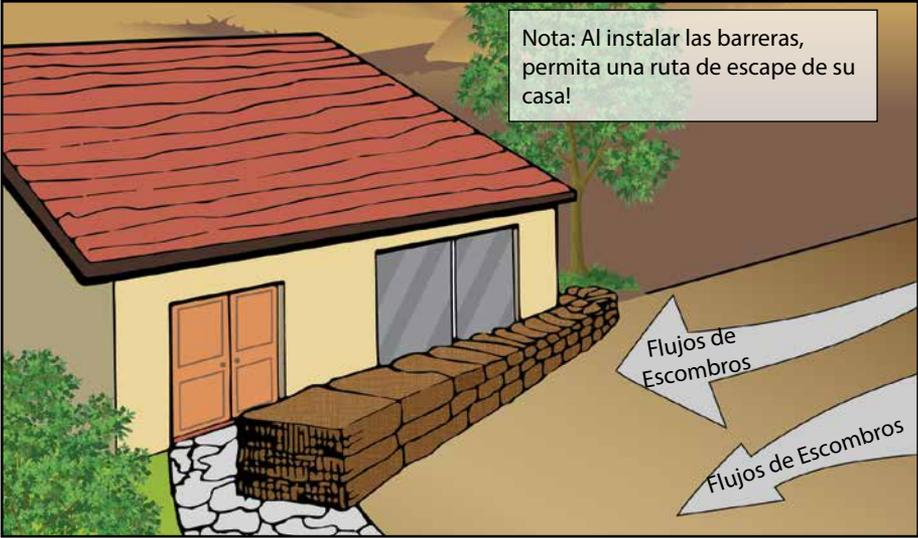
Fig. 10 - Protección de Edificios
